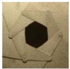
Диафрагма также оказывает влияние на глубину резкости. Чем меньше диафрагма, т.е. больше число диафрагмы, тем круп-нее глубина резкости. Так, снимок на рисунке, слева, был сделан при диа-фрагме 3,4, а снимок справа — при диафрагме 11.
